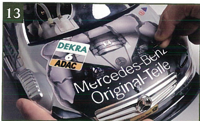
13 Удостоверившись, что колеса не цепляют за кузов и вращаются свободно, закрепите кузов на раме при помощи стальных клипс.
