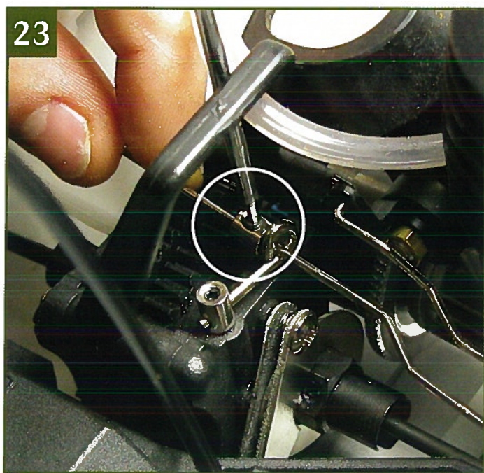
23 Установите головку сервопривода и закрепите ее на тяге, затянув винт (регулировка тяг — см. № 63, «Автомоделизм. Советы», стр. 137–138). Привинтите качалку сервопривода к шестерне сервопривода.
