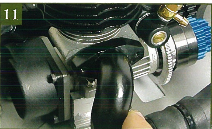
11 Установите выпускной коллектор на место в правильное положение и закрепите его, затянув один из болтов со стопорной шайбой.
