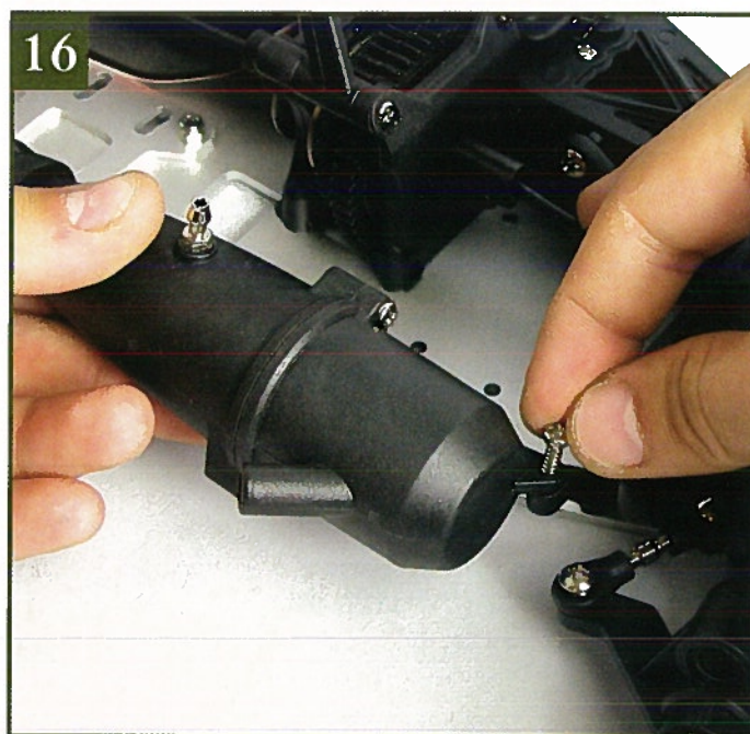
16 Соедините глушитель со стойкой крепления выхлопной трубы, как показано на фото. Затем закрепите его при помощи снятого вами самореза.
