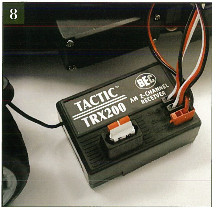
8 Извлеките из набора радиоплаты ресивер и воткните коннектор сервопривода рулевого управления в канал № 1.
