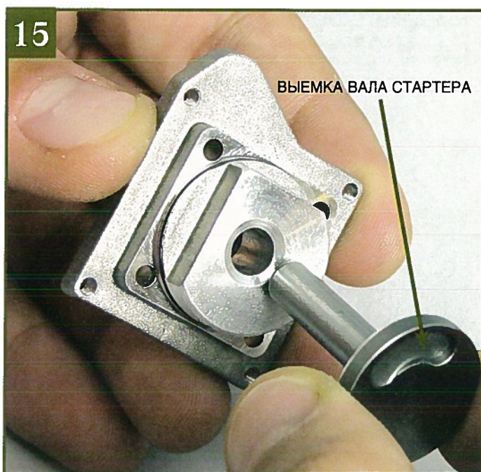
15 Сняв односторонний подшипник, который вы временно установили в № 47, вставьте вал стартера в заднюю крышку. Обратите внимание на правильное положение деталей.
