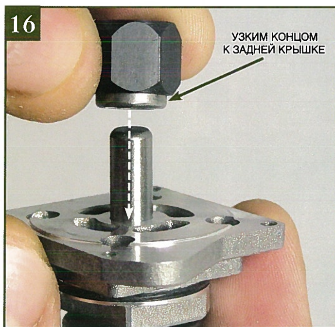
16 Теперь вы можете снова установить односторонний подшипник на вал стартера. Обратите внимание на взаимное расположение деталей (см. фото).
