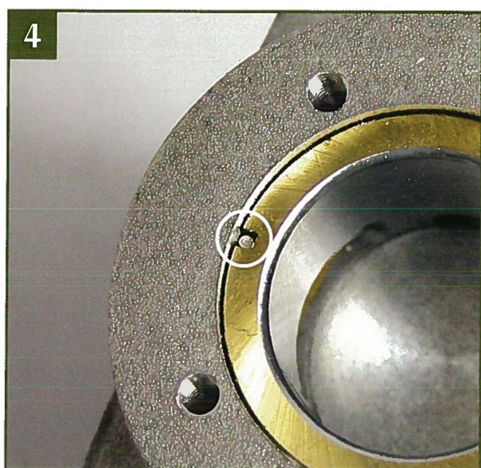
4 Сориентируйтесь по желобку (см. белый кружок на фото), чтобы правильно выставить гильзу цилиндра относительно картера.
