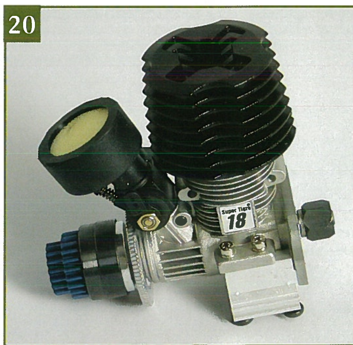
20 Ваш двигатель почти готов. Не пытайтесь прокрутить его вручную: гильза цилиндра имеет коническое сечение, и поршень не может проделать полный путь вверх. Это абсолютно нормально для нового двигателя.
