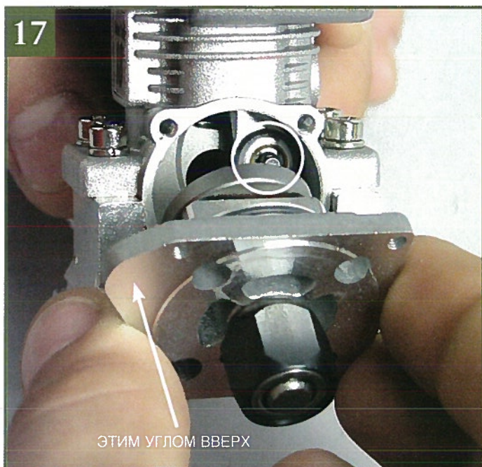
17 Заведите штифт вала стартера в выемку вала стартера (обведено белым). Сверьтесь с фото в пункте 15, чтобы понять, о чем идет речь. Затем совместите крепежные отверстия на задней крышке двигателя и картере.
