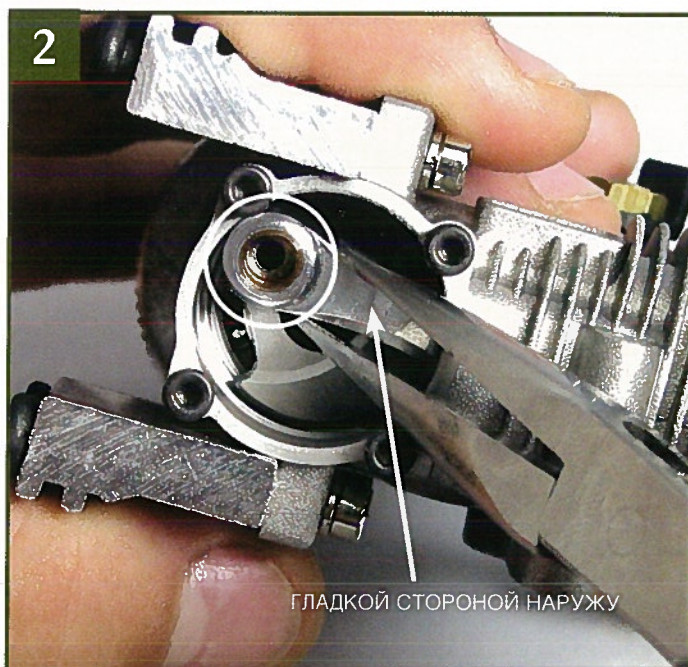
2 Используя длинногубцы, соедините шатун со штифтом коленчатого вала. Обратите внимание: гладкая сторона шатуна должна смотреть наружу, а сторона с желобком – внутрь двигателя (см. пункт 12).
