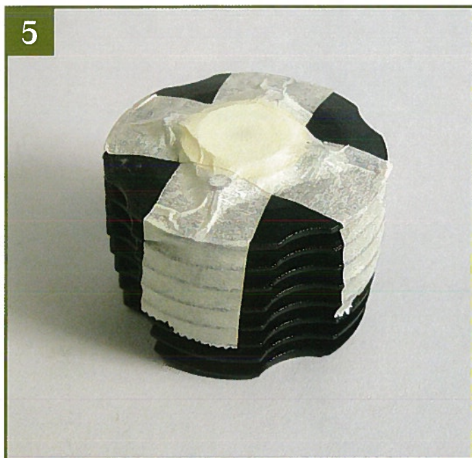
5 Возьмите головку двигателя. В № 61 (стр. 216) вы произвели предварительную сборку верхней крышки камеры сгорания, прокладок регулировки объема камеры сгорания, свечи накалывания и болтов.
