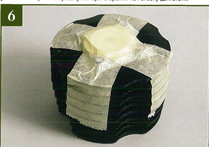
6 Воспользуйтесь двумя полосками малярного скотча, чтобы прикрепить детали к головке двигателя. Уберите инструменты и детали в надежное место.
