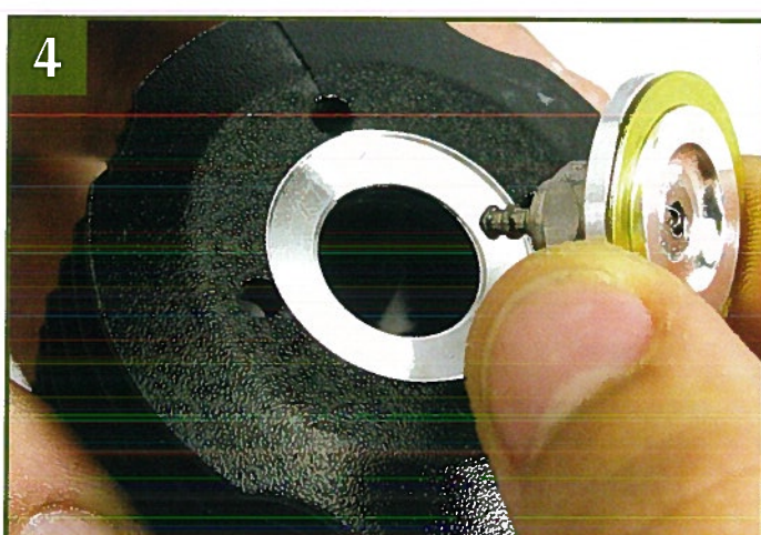
4 Возьмите головку двигателя и четыре болта под шестигранник, полученные вами с № 56. Внимательно сверьтесь с фото, после чего установите верхнюю крышку камеры сгорания на головку двигателя.
