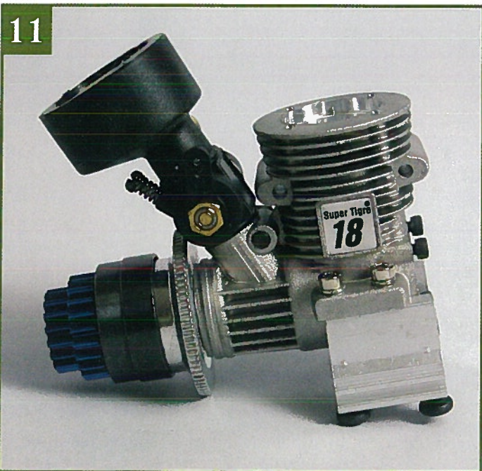
11 На фото показано правильное расположение воздушного фильтра. Прежде чем перейти к следующему шагу, удостоверьтесь, что вы все сделали правильно.
