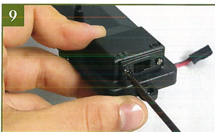
9 Удостоверившись в правильности сборки, зафиксируйте выключатель при помощи малой крестовой отвертки.
