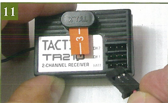
11 Соедините второй выход выключателя с соответствующим слотом, помеченным «BATT».
