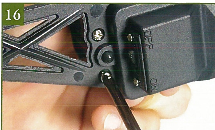
16 Используя второй саморез 3×10 мм, завершите соединение между задней стойкой крепления сервомашинки и набором радиоплаты.
