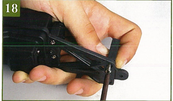
18 Соединив детали, вставьте и затяните саморез 3×10 мм, заведя его в соответствующее отверстие.
