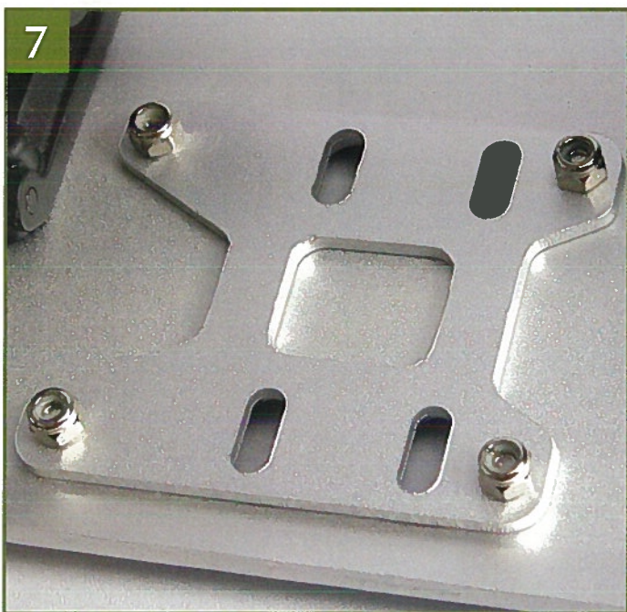
7 Для закрепления монтажной пластины на шасси установите оставшиеся два болта в той же последовательности.
