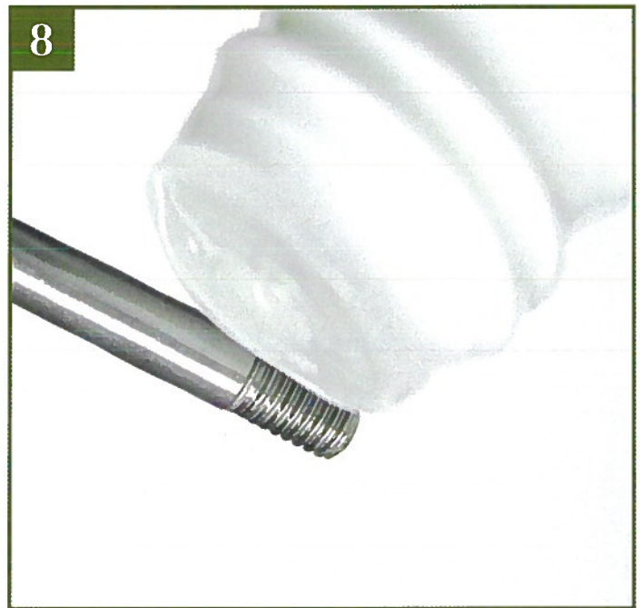
8 Смажьте шток амортизатора небольшим количеством масла, полученного с № 39. Это поможет избежать повреждения уплотнительных колец.
