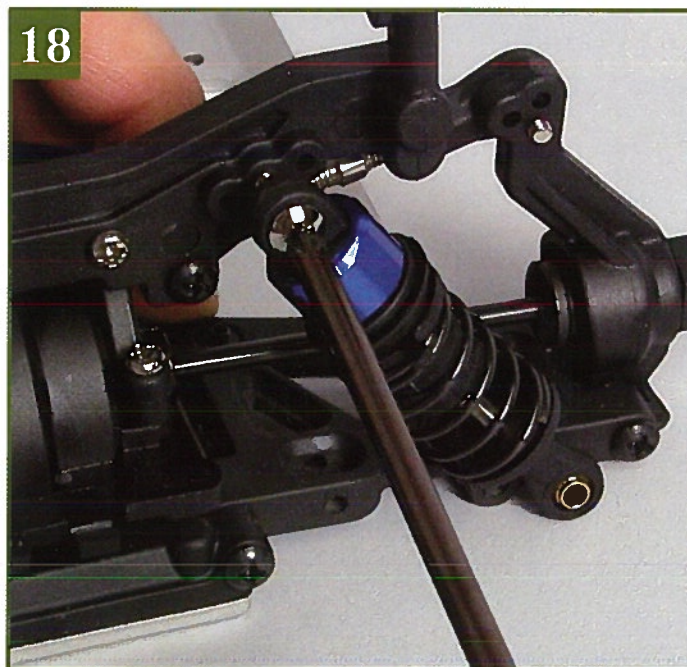
18 Используя винт с полукруглой головкой и втулку крепления амортизатора, закрепите верхний конец правого амортизатора на задней стойке крепления амортизаторов. Мы рекомендуем вам воспроизвести шаги 1, 2 и 3, приведенные в № 45 на стр. 148.
