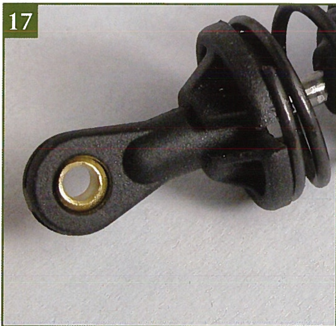
17 Зафиксируйте пружину, установив на шток нижнюю опору пружины. Затем установите шар в отверстие на шаровой.
