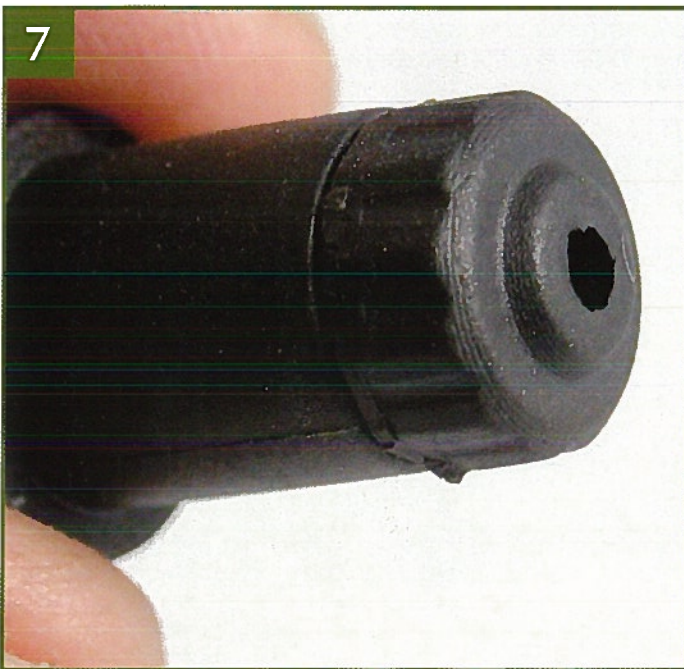
7 Закройте днище амортизатора соответствующей крышкой. Затяните ее плотно, но не перетягивайте.
