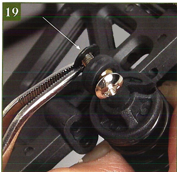
19 Чтобы закрепить нижний конец амортизатора на нижнем заднем рычаге подвески, вам понадобится второй винт с полукруглой головкой и большая пластиковая шайба, обозначенная белой стрелкой.
