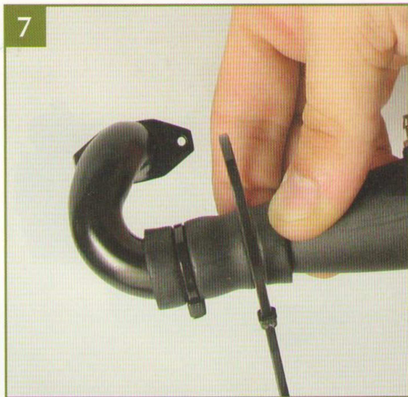
7 Нейлоновую стяжку, прилагавшуюся к № 53, наденьте на свободный желобок на соединительном патрубке. Прежде чем затянуть стяжку, удостоверьтесь, что все детали стоят правильно.
