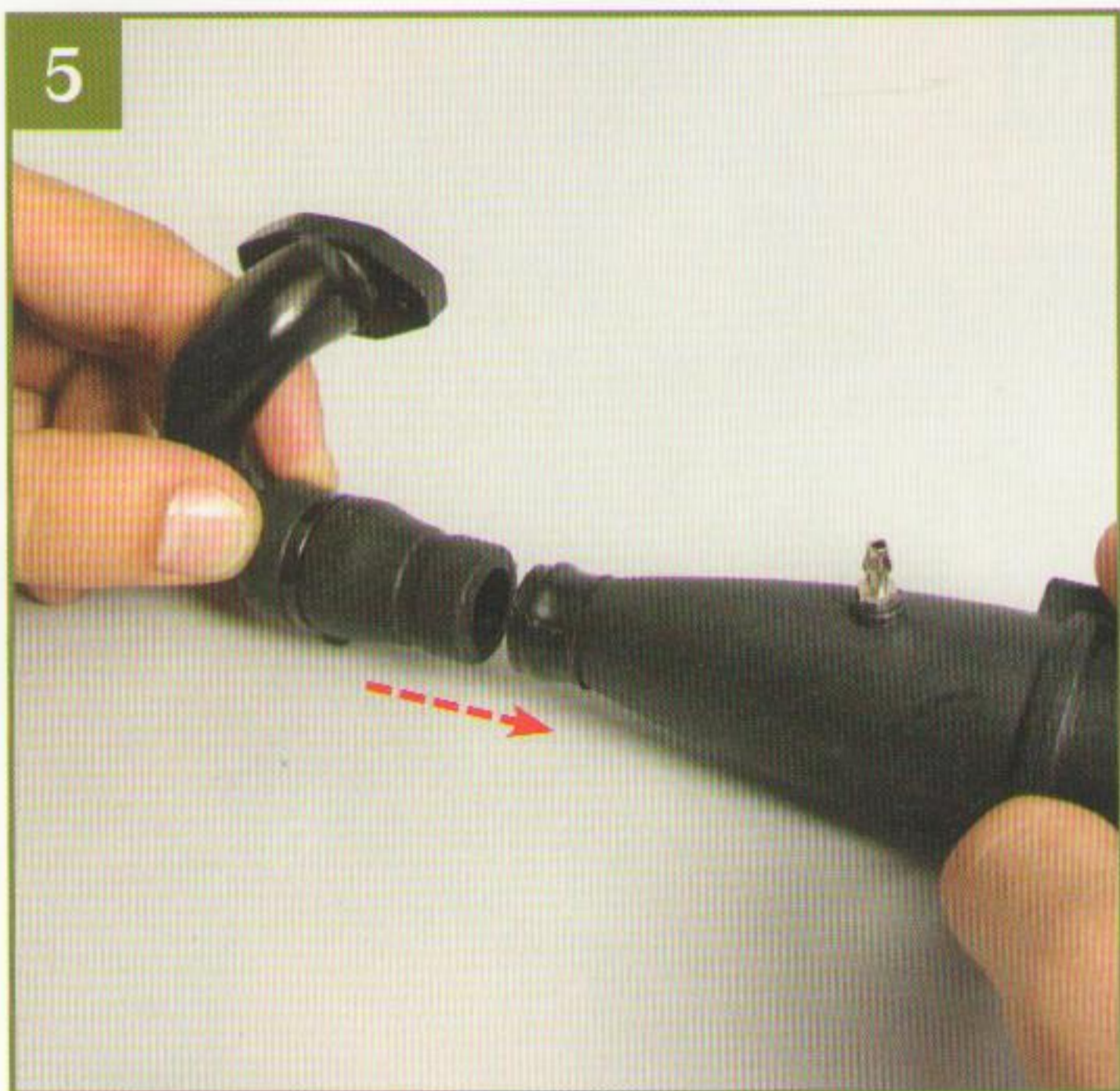
5 Возьмите выпускной коллектор из № 53, намочите внутреннюю часть соединительного патрубка и наденьте его на глушитель.
