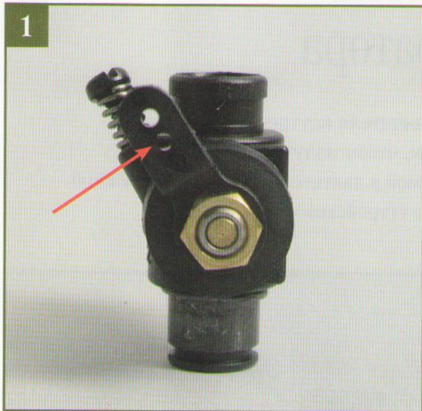
1 Обратите внимание на левую сторону карбюратора. Вы видите рычаг управления дроссельной заслонкой (показан красной стрелкой).
