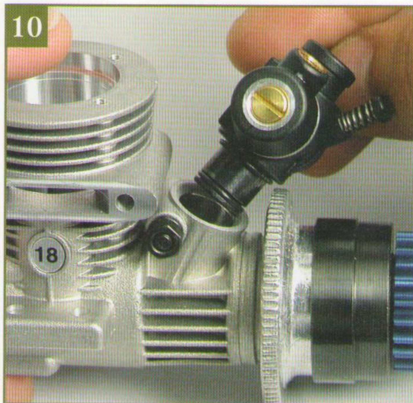
10 Вставьте карбюратор в отверстие, как показано на фото.
