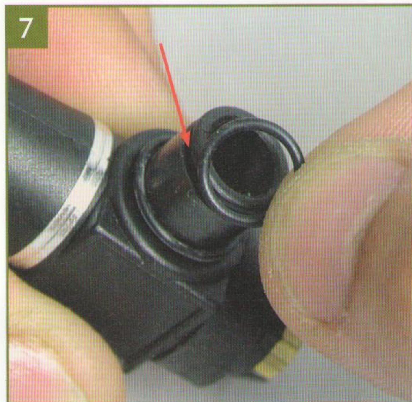
7 Возьмите уплотнительное кольцо, прилагавшееся к № 39. Красной стрелкой показан желобок, на который необходимо установить это кольцо.
