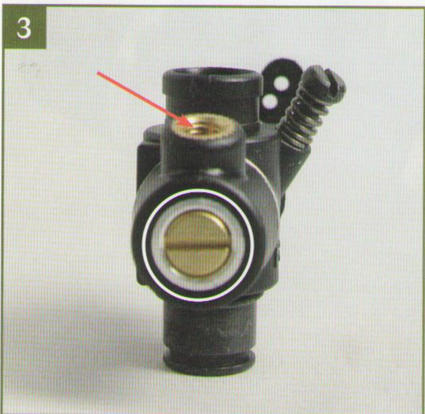
3 С правой стороны находится регулировочный винт иглы настройки количества смеси (обведен белым). Красная стрелка указывает на отверстие для подачи топлива и установки иглы, которую вы получите с № 60.
