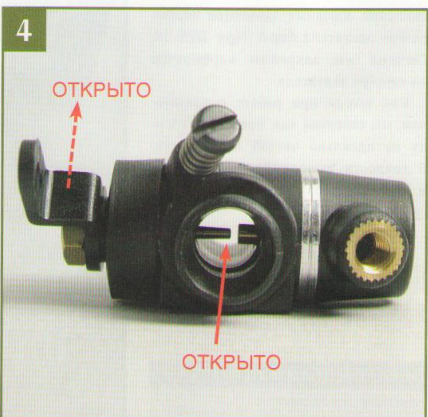
4 На фото вы видите карбюратор с рычагом управления дроссельной заслонкой в открытом положении. Соответственно, вращающаяся задвижка тоже находится в открытом положении.
