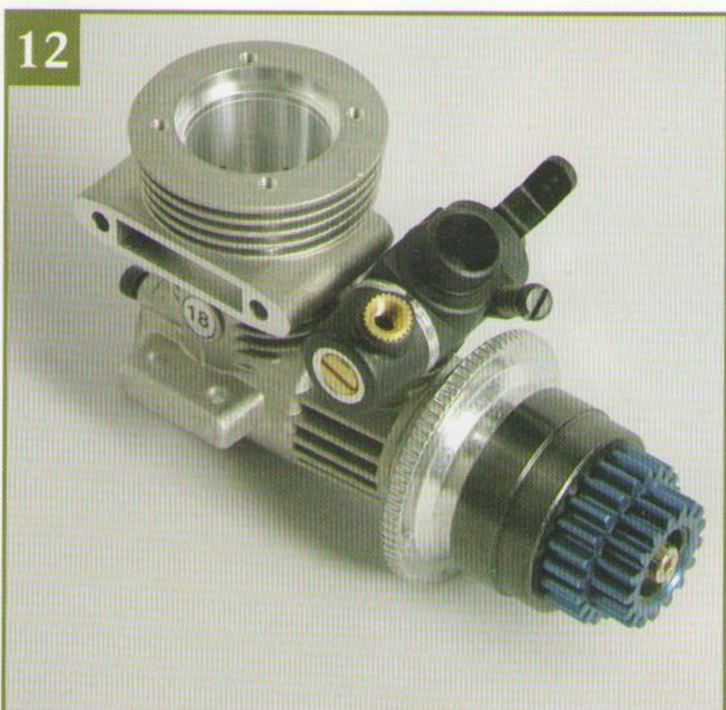
12 Перед вами результат сборки. Карбюратор установлен на картер.
