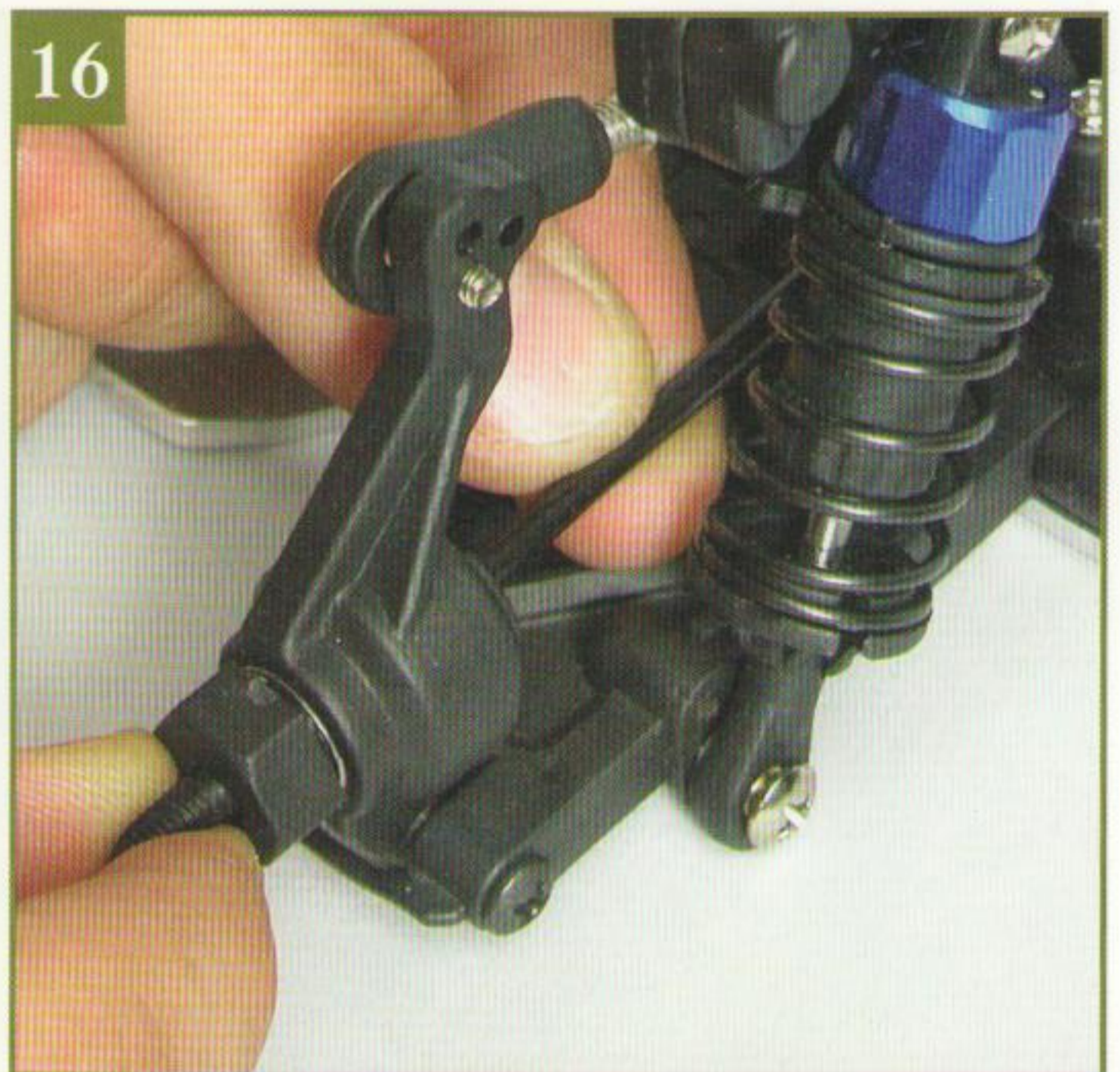
16 Возьмите шестигранник крепления колеса и наденьте его на полуось. Заведите штифт в соответствующие прорези.
