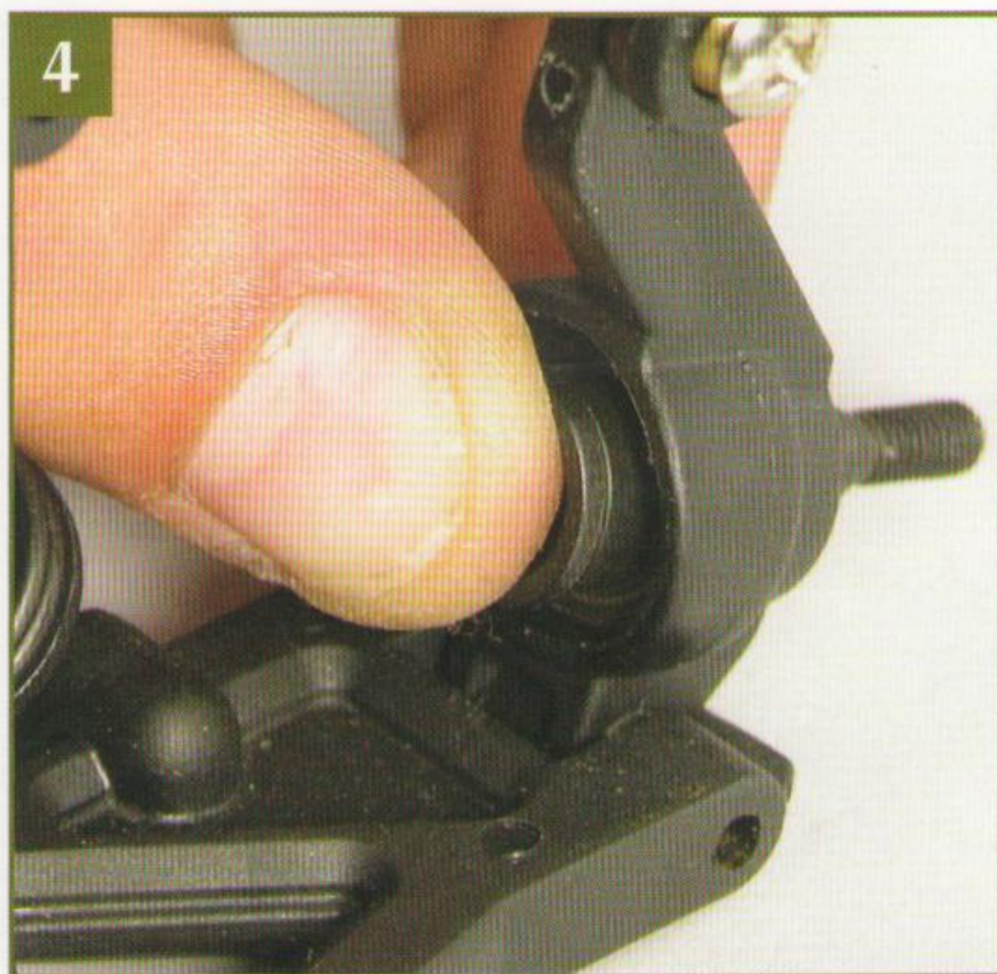
4 Протолкните полуось наружу таким образом, чтобы она плотно села на большой подшипник.
