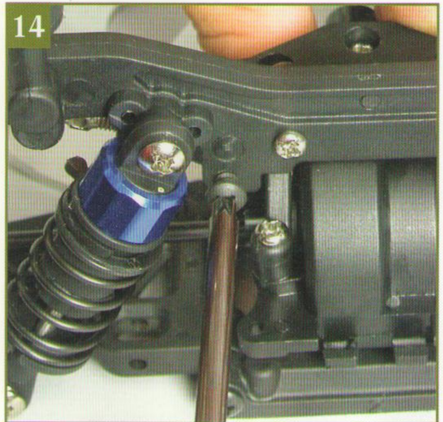
14 С помощью отвертки затяните до конца винт крепления верхней тяги, не перетягивая его.
