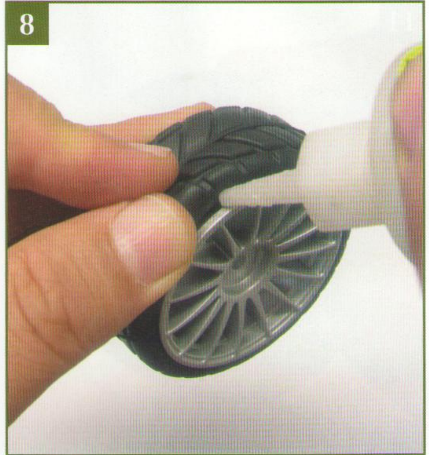
8 Слегка приподнимите покрышку и капните под нее моментальный клей ЦА.
