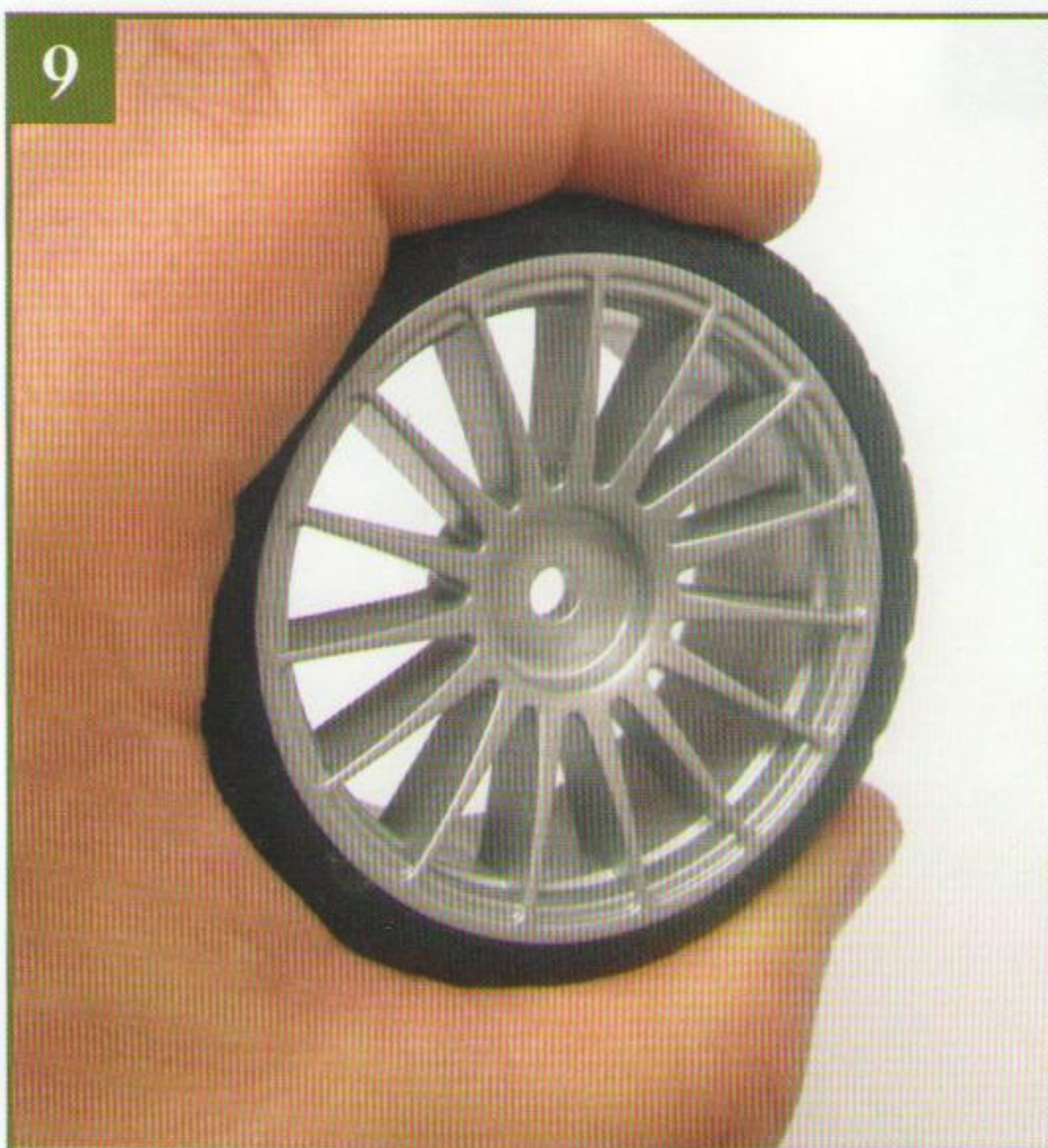
9 Отпустите покрышку и прижмите ее к колесному диску, чтобы дать клею схватиться.
