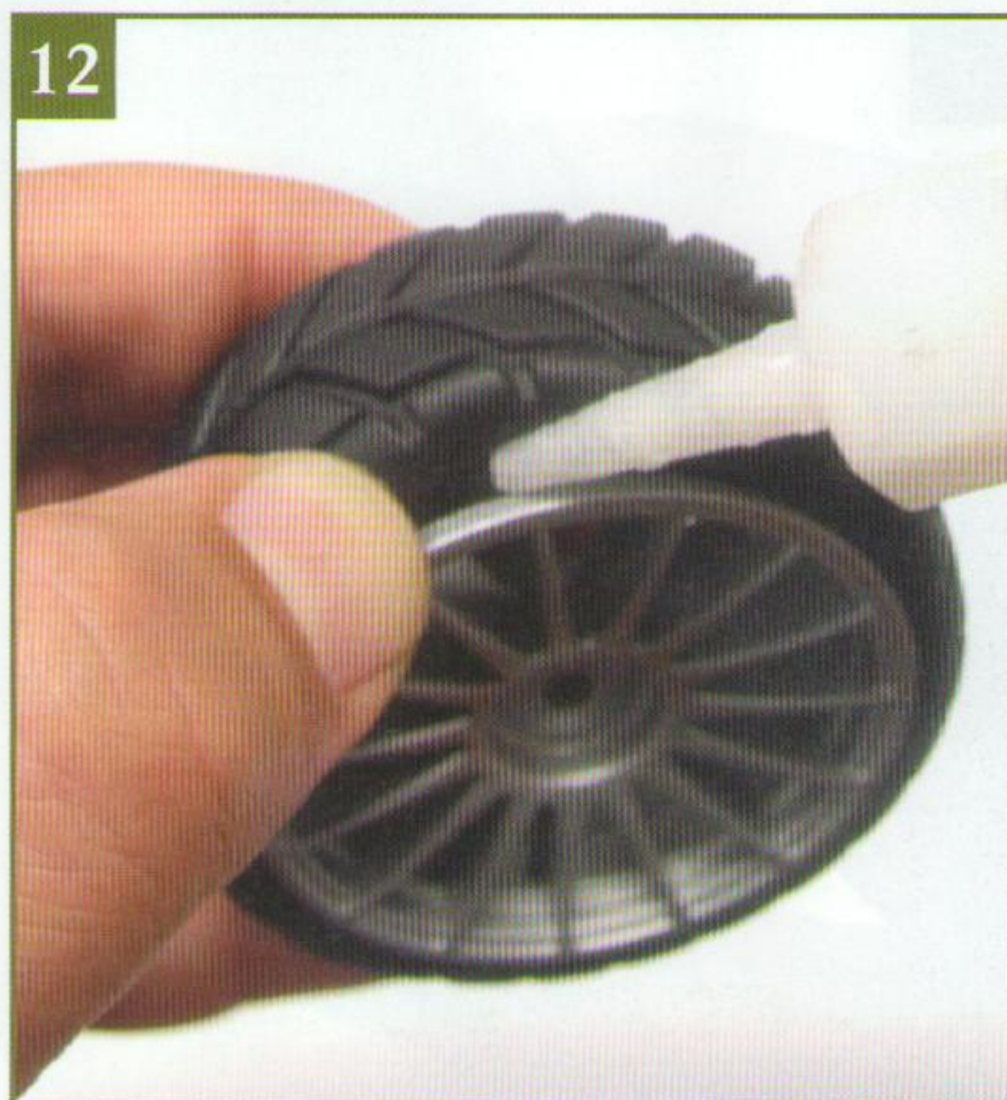
12 Слегка приподняв непроклеенные края покрывки, промажьте ее небольшим количеством клея по кругу. Не используйте слишком много клея и не оставляйте непроклеенных участков.
