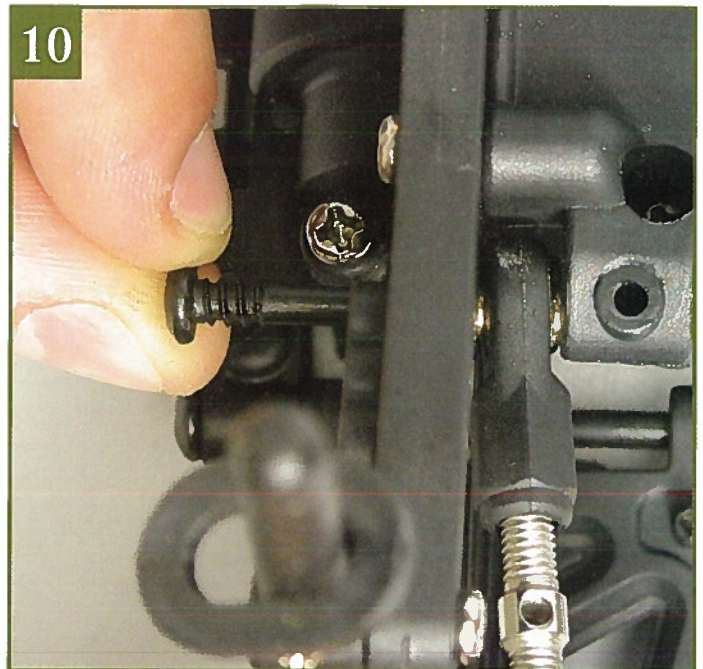
10 Возьмите винт крепления верхней тяги, полученный с № 6, и заведите его через шаровую тяги в корпус дифференциала.
