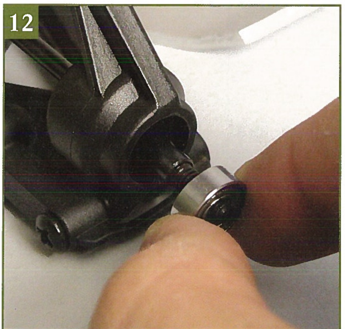
12 Возьмите один из двух подшипников 5×11 мм и наденьте его на конец колесной оси. Заведите его до упора.
