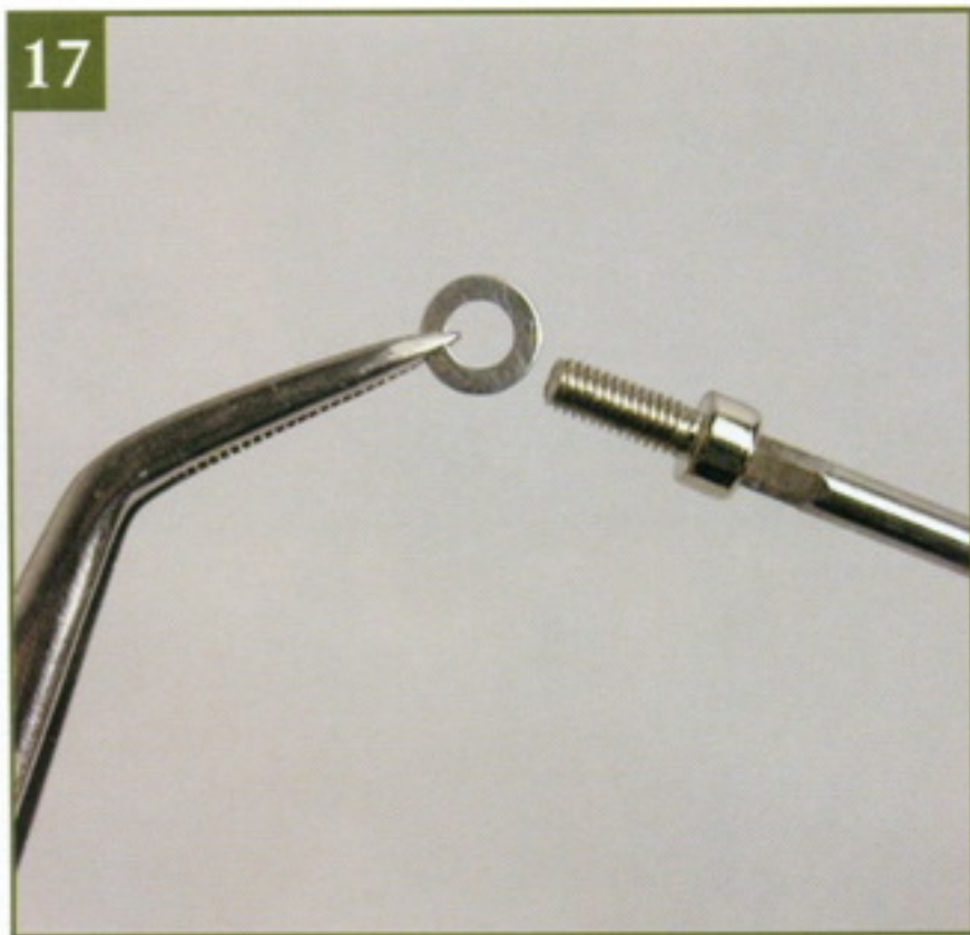
17 Наденьте запирающий болт сцепления на шестигранный ключ 1,5 мм. Наденьте на резьбу болта малую шайбу.
