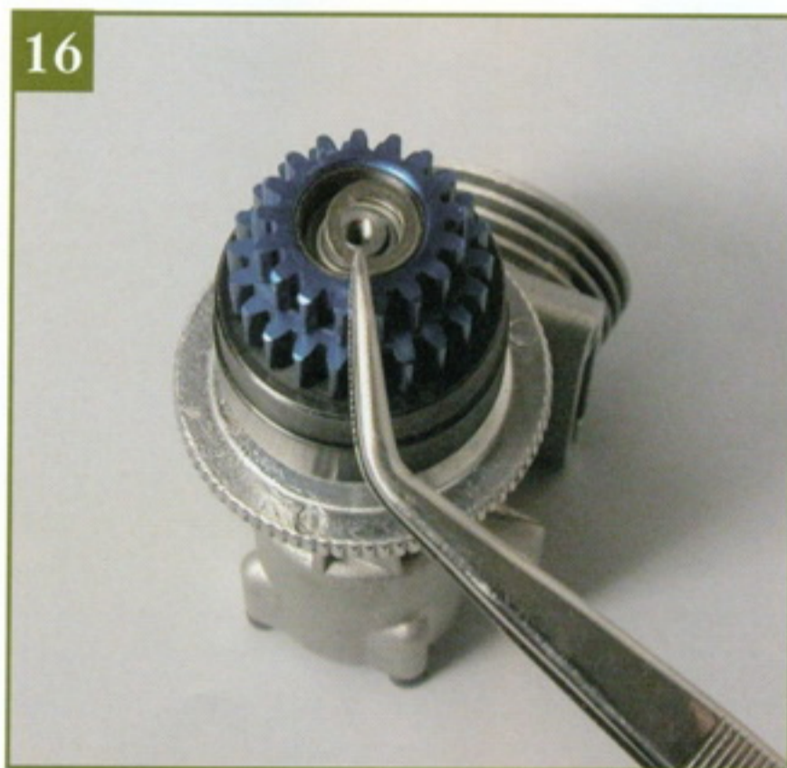
16 Используя пару длинногубцев, установите на подшипник вторую большую шайбу.
