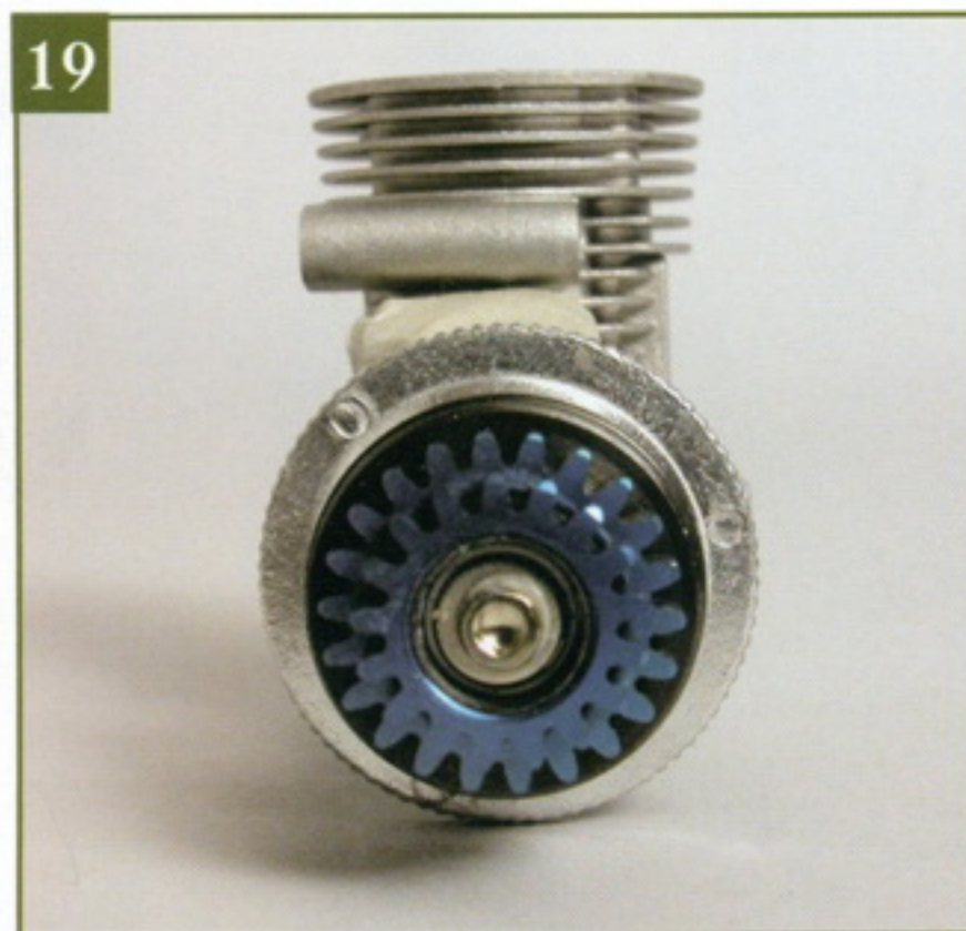
19 Сборка сцепления завершена. Оно надежно зафиксировано на передней части картера двигателя.
