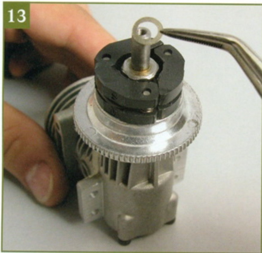
13 Положите картер двигателя таким образом, чтобы сцепление смотрело вверх. Используйте пару длинногубцев, чтобы установить на гайку одну из двух больших шайб.
