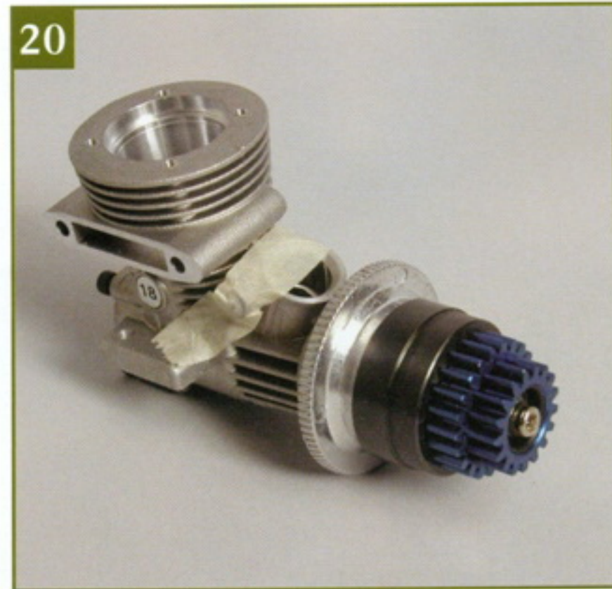
20 После завершения сборки сцепление должно свободно вращаться вокруг своей оси. Удостоверьтесь в этом, прежде чем убрать детали и инструменты.
