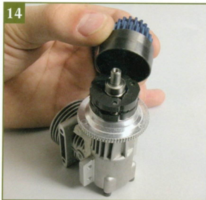
14 Установите на место колокол сцепления. Удостоверьтесь, что штифт гайки прошел через установленные ранее подшипники.
