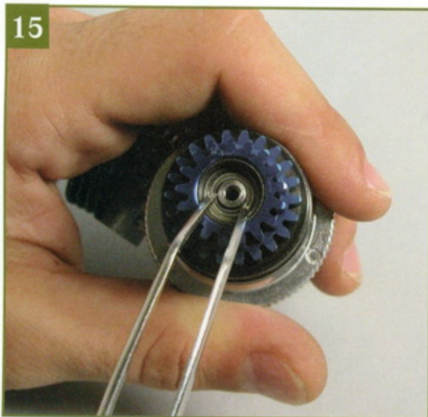
15 Убедитесь в правильном положении подшипника, установленного на колокол сцепления. При необходимости опустите его вниз, как показано на фото.
