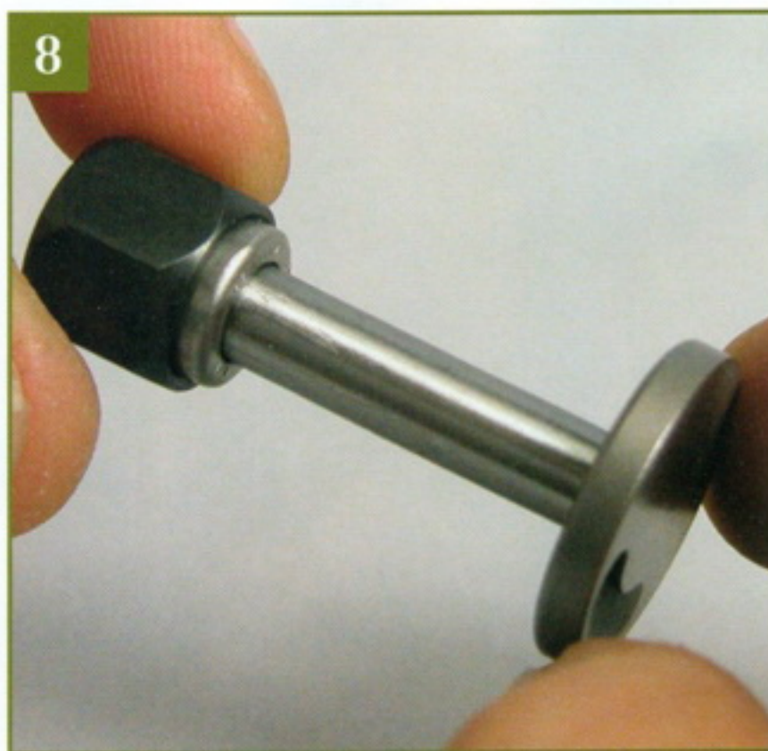
8 Соедините вал стартера и односторонний подшипник, как показано на фото.
