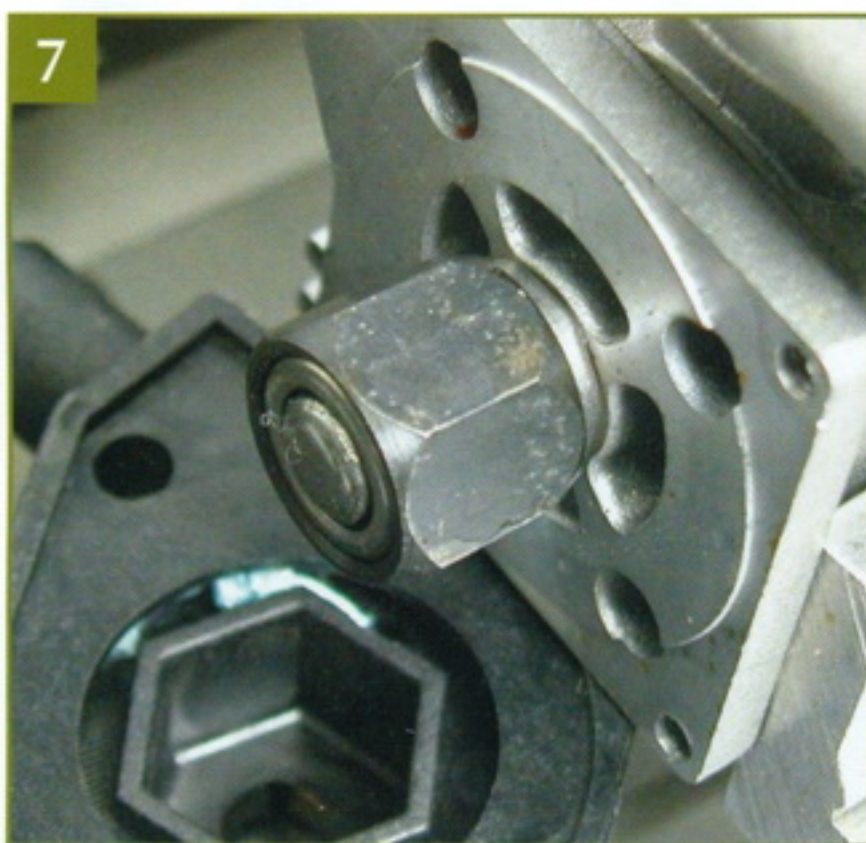
7 На фото показан односторонний подшипник в сборе. Обратите внимание на то, как ориентирован односторонний подшипник.
