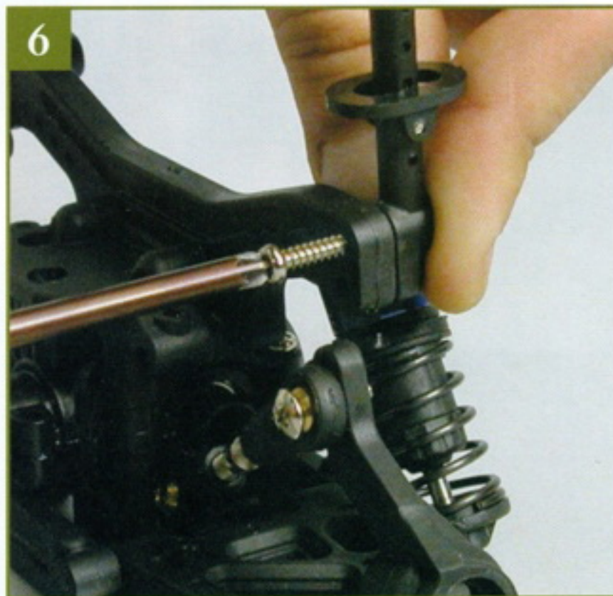
6 Соедините заднюю стойку кузова с задней стойкой крепления амортизаторов при помощи самореза 3×12 мм. Затем отложите эти детали в сторону.
