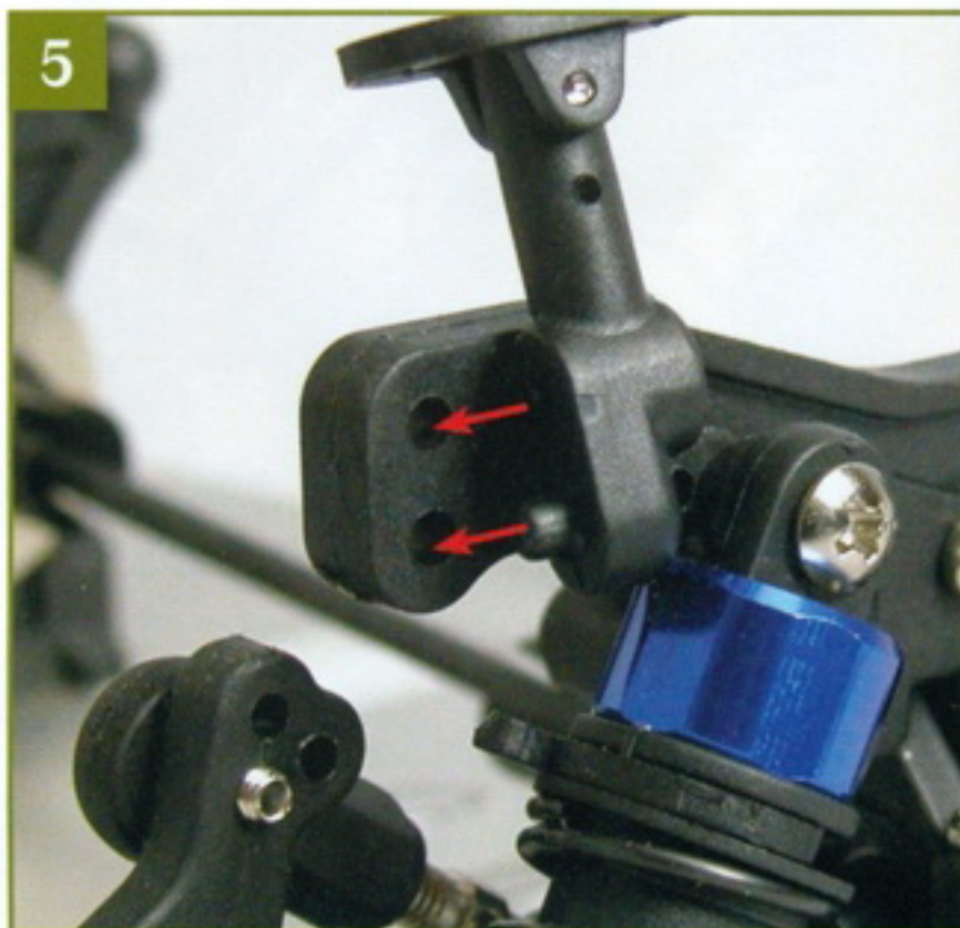
5 Теперь мы можем установить заднюю стойку кузова с левой стороны задней стойки крепления амортизаторов.
