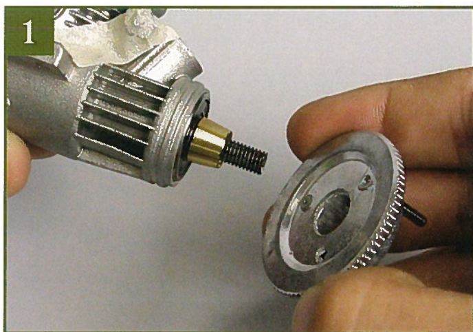
1 Сняв липкую ленту с конца коленного вала, проведите предварительную установку маховика. Положите картер двигателя на рабочую поверхность.
