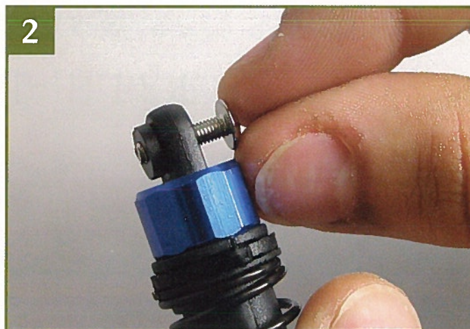
2 Вставьте винт с полукруглой головкой (деталь 8 из перечня на стр.115) во втулку. Затем положите перед собой раму вашей радиоуправляемой модели.
