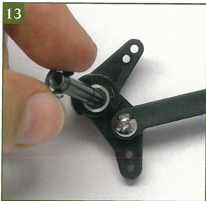
13 Положите рулевую колонку в сборе на рабочий стол, как показано на фото. Вставьте черный цилиндр рулевой колонки с надетой на него стопорной пружинной шайбой (см. шаг 6) в серебристый цилиндр.
