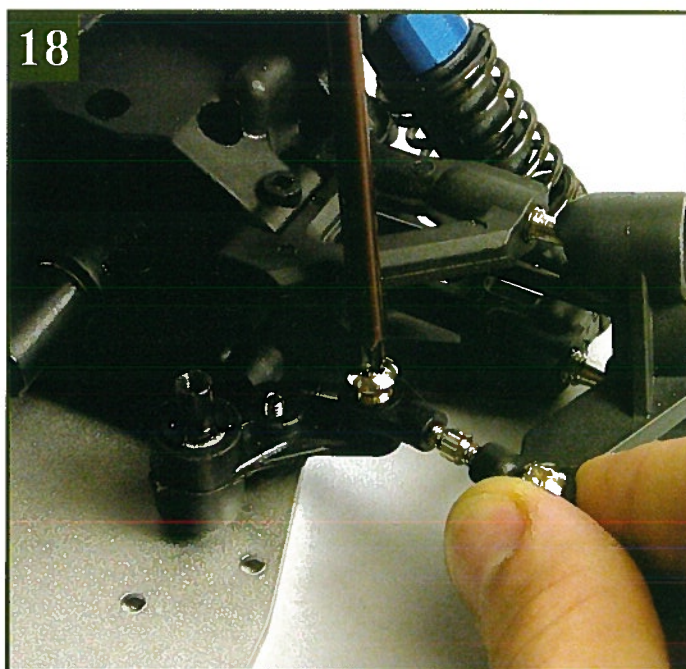
18 Возьмите два винта с крестообразным шлицем 3×10 мм из № 40, совместите внешнее отверстие на правом рычаге рулевой колонки с концом рулевой тяги. Соедините их винтом 3×10 мм.
