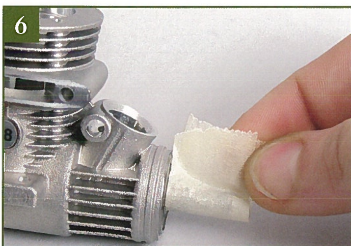
6 Замотайте конец коленного вала с резьбой малярным скотчем, чтобы не дать валу выпасть.
