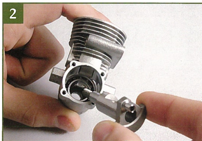
2 Возьмите картер двигателя из № 35 и вставьте коленный вал в отверстие картера с задней стороны.
