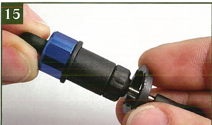
15 Закройте амортизатор крышкой. Наденьте на корпус верхний упор пружины.
