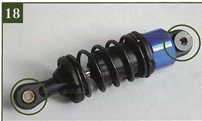
18 Завершите сборку третьего амортизатора, установив на позиции, обведенные зеленым, шар наконечника амортизатора и втулку верхней крышки.
