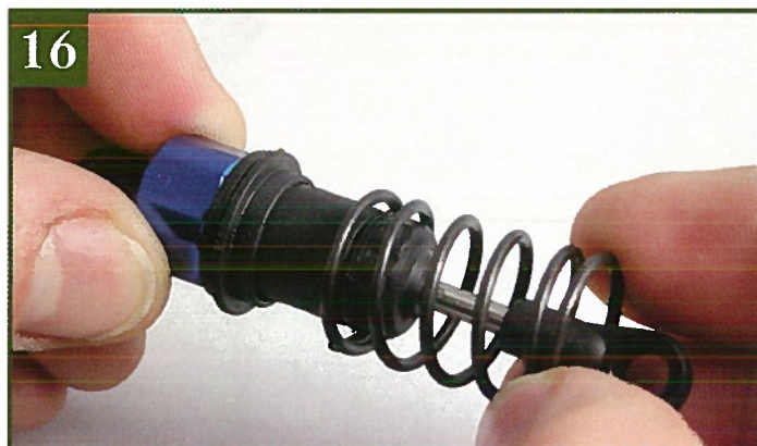
16 Уприте пружину в верхний упор.
