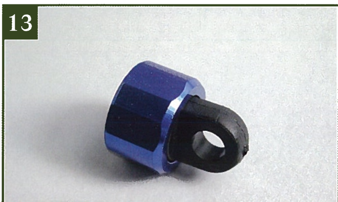
13 Вставьте крышку амортизатора в верхнюю алюминиевую крышку.
