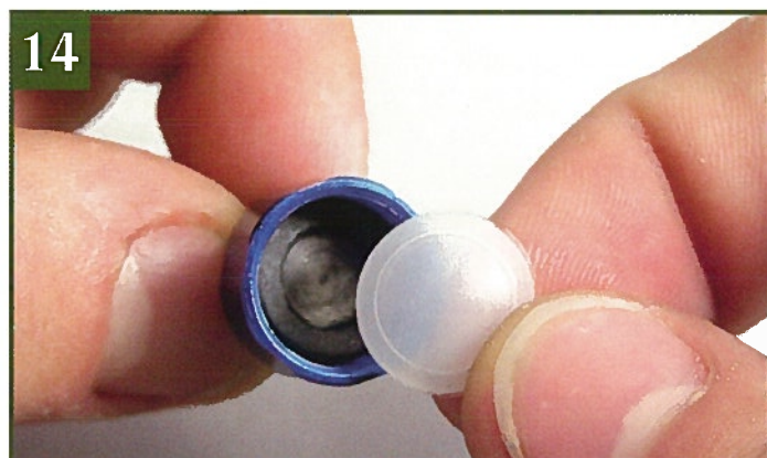
14 Поместите внутрь крышки амортизатора диафрагму, как показано на фото.
