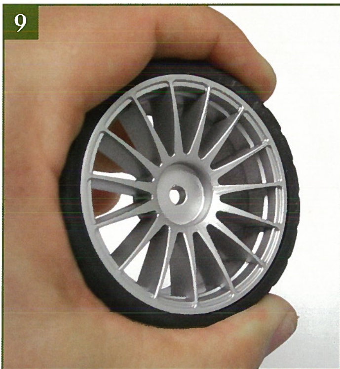
9 Отпустите покрывку и прижмите ее к колесному диску, чтобы дать клею схватиться.
