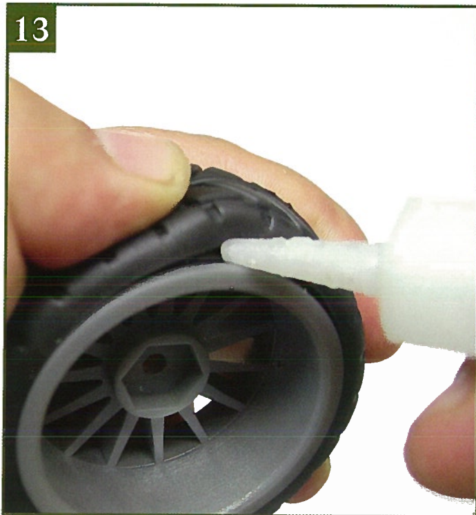
13 Повторите эту операцию с внутренней стороны колеса и дайте клею как следует высохнуть.
