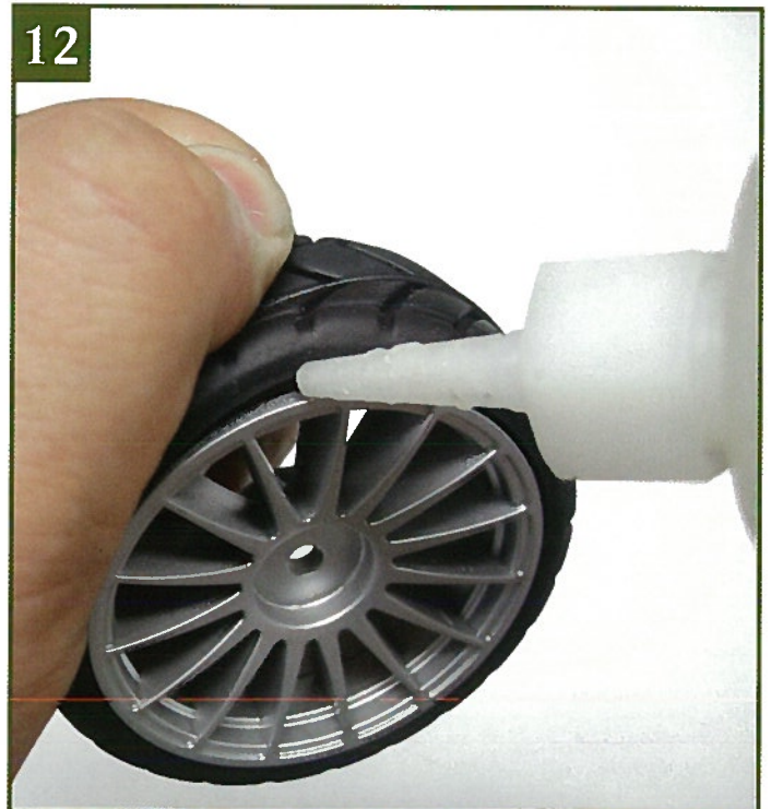
12 Слегка приподняв непроклеенные края покрышки, промажьте ее небольшим количеством клея по кругу. Не используйте слишком много клея и не оставляйте непроклеенных участков.
