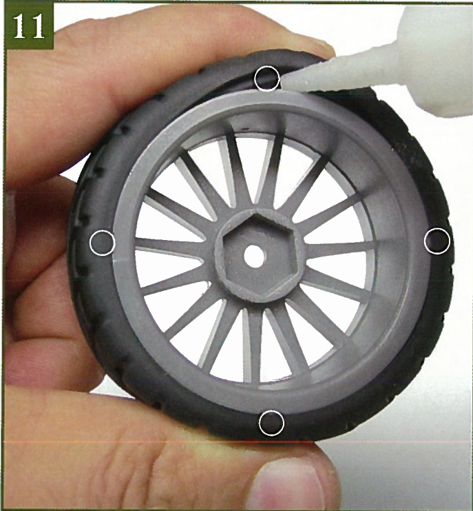
11 Склейте покрышку и колесный диск в четырех точках с внутренней стороны.
