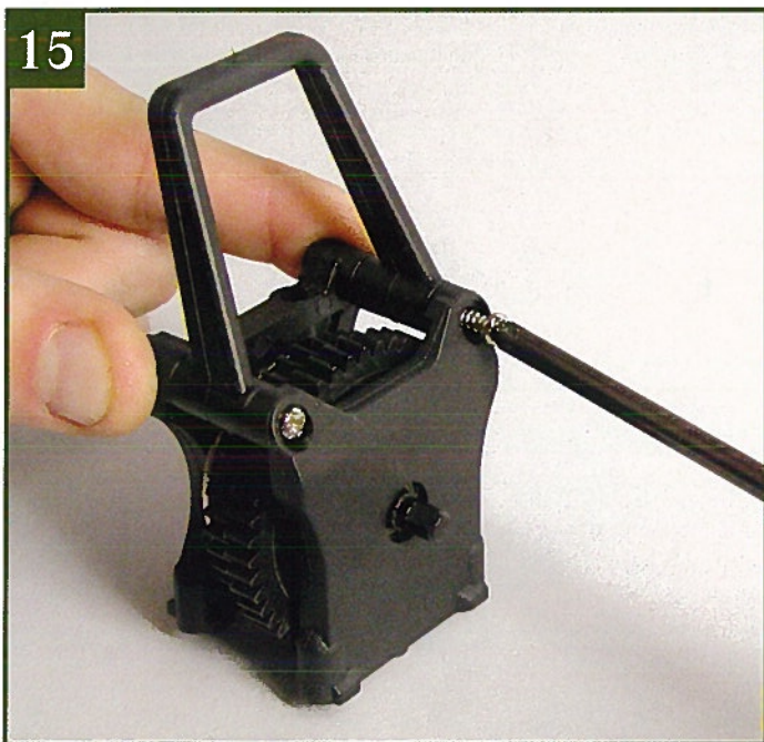
15 Воспользуйтесь отверткой, чтобы затянуть саморезы. Не перетяните их.
