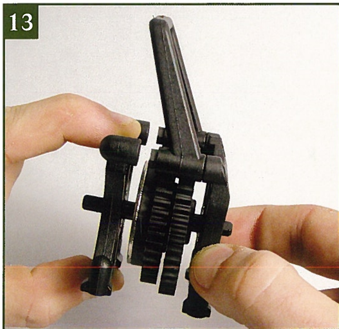
13 Установите на место заднюю стойку крепления КПП. Центральный вал трансмиссии должен пройти через подшипник, а шестигранные оконечники ручки занять свое место в соответствующих отверстиях стойки.
