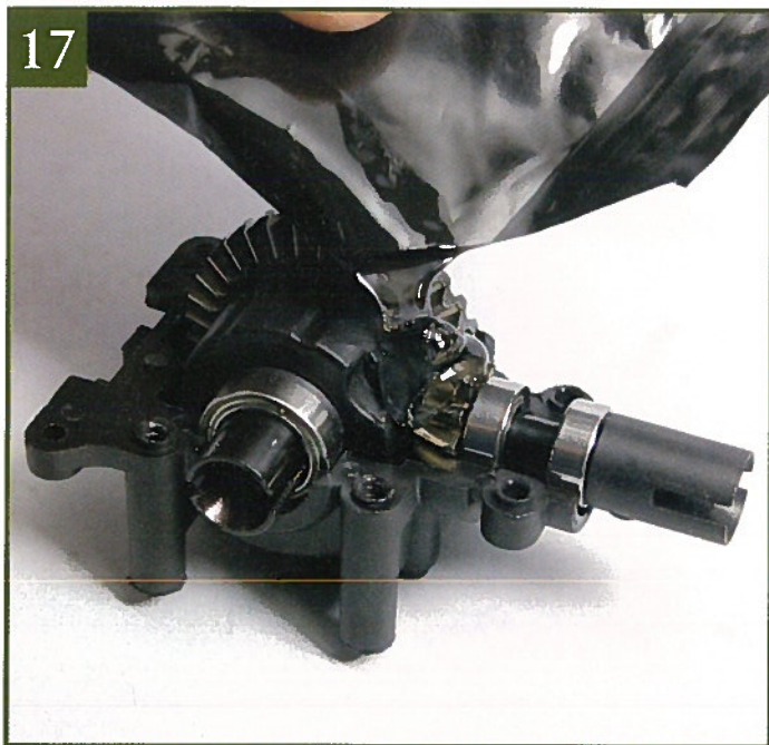
17 Возьмите пакетик с остатками масла дифференциала и смажьте внешнюю поверхность шестерни дифференциала. Закройте пакетик и уберите оставшееся масло в надежное место.
