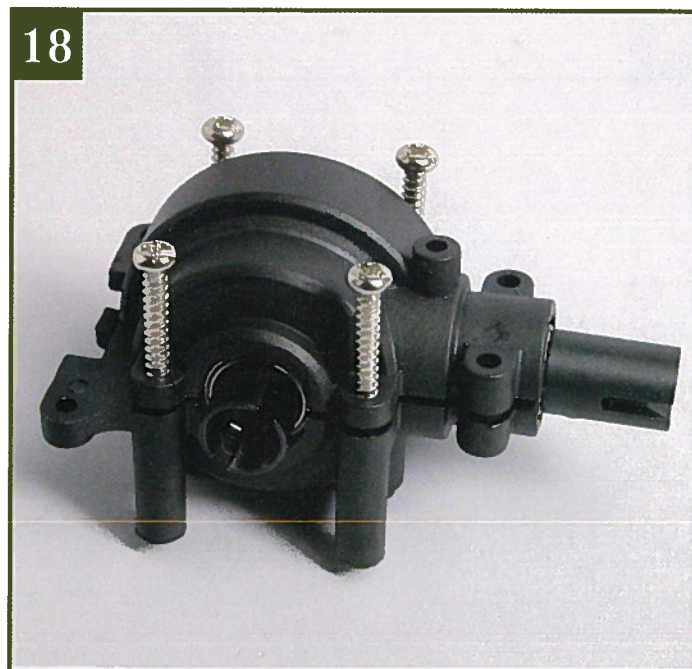
18 Установите верхнюю половину картера дифференциала на нижнюю и совместите отверстия четырех соединительных саморезов.
