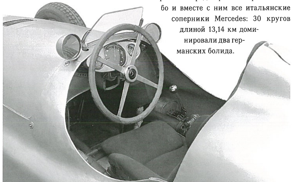
Слегка асимметричный кокпит W 165. Основной топливный бак располагался непосредственно перед водителем.
