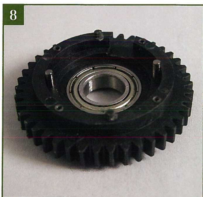
8 На фото сверху показан результат: пластиковая шестерня (тыльной стороной) с двумя стальными штифтами, готовая к установке шайбы крепления вариатора коробки передач.
