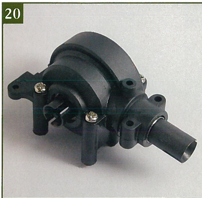
20 Сборка первого дифференциала вашей радиоуправляемой гоночной модели завершена. Уберите дифференциал и инструменты в надежное место.
