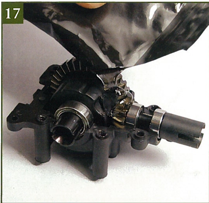
17 Возьмите пакетик с остатками масла для дифференциала и смажьте внешнюю поверхность шестерни дифференциала. Закройте пакетик и уберите оставшееся масло в надежное место.
