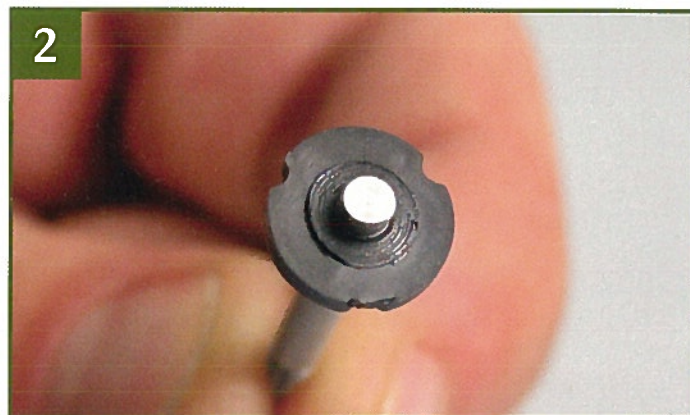
2 Затем установите на шток поршень амортизатора, оперев его на E-клипсу.
