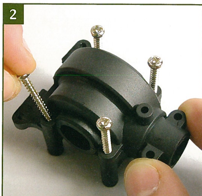
2 Положите деталь в сборе на рабочую поверхность так, чтобы верхняя часть картера смотрела вверх. Вставьте четыре самореза в соответствующие отверстия и затяните их вручную на пару оборотов каждый.
