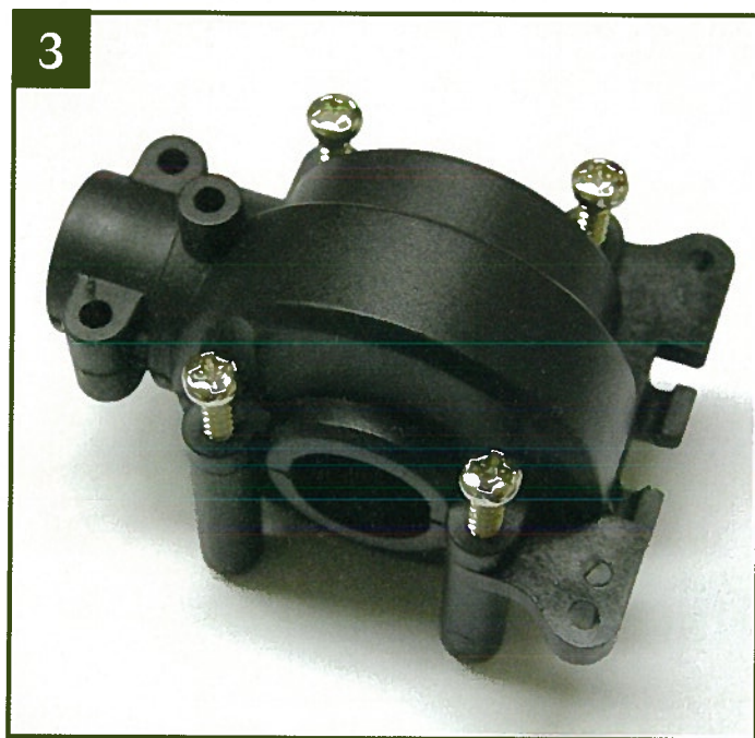
3 Возьмите крестовую отвертку и затяните винты крест-накрест, чтобы добиться максимального прилегания друг к другу обеих половин картера.
