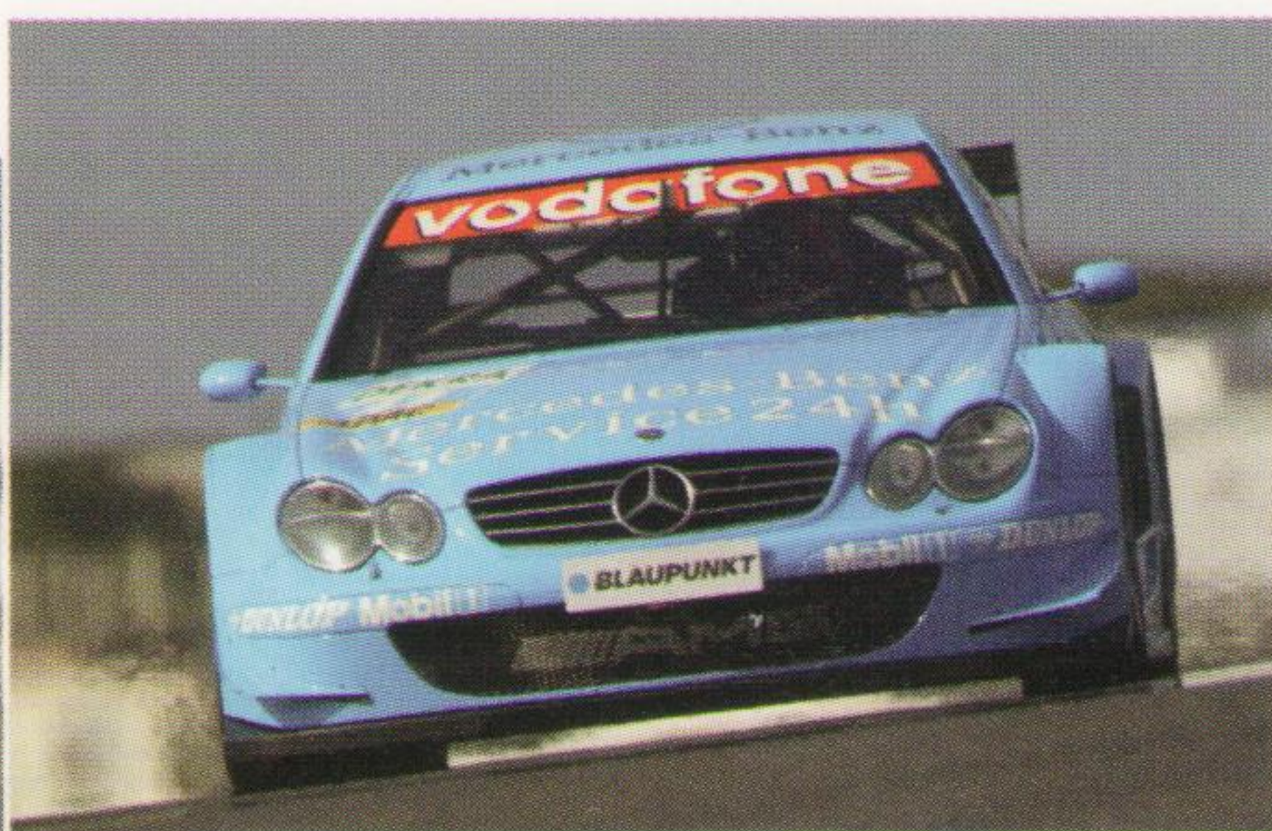
Наиболее заметные отличия моделей сезона-2003 (слева) и 2002 (вверху): углы воздухозаборника новой модели опущены вниз — машина перестала «улыбаться».
