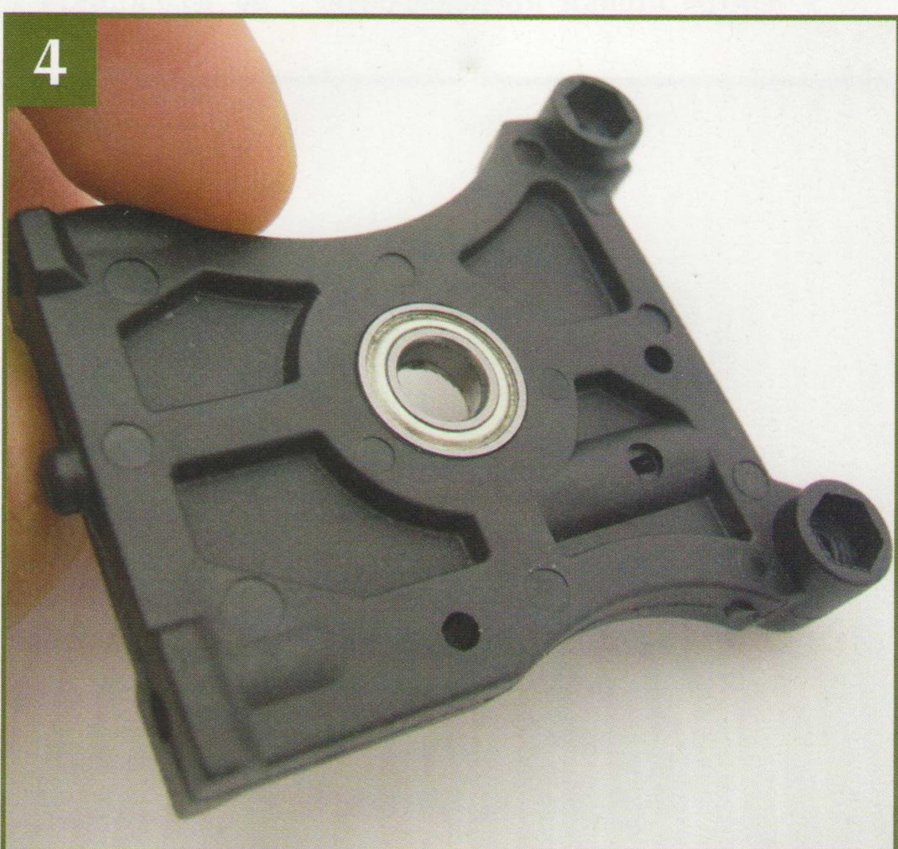
4 На фото вы видите подшипник и стойку крепления КПП после установки. Уберите детали в надежное место, чтобы не потерять и не повредить их.
