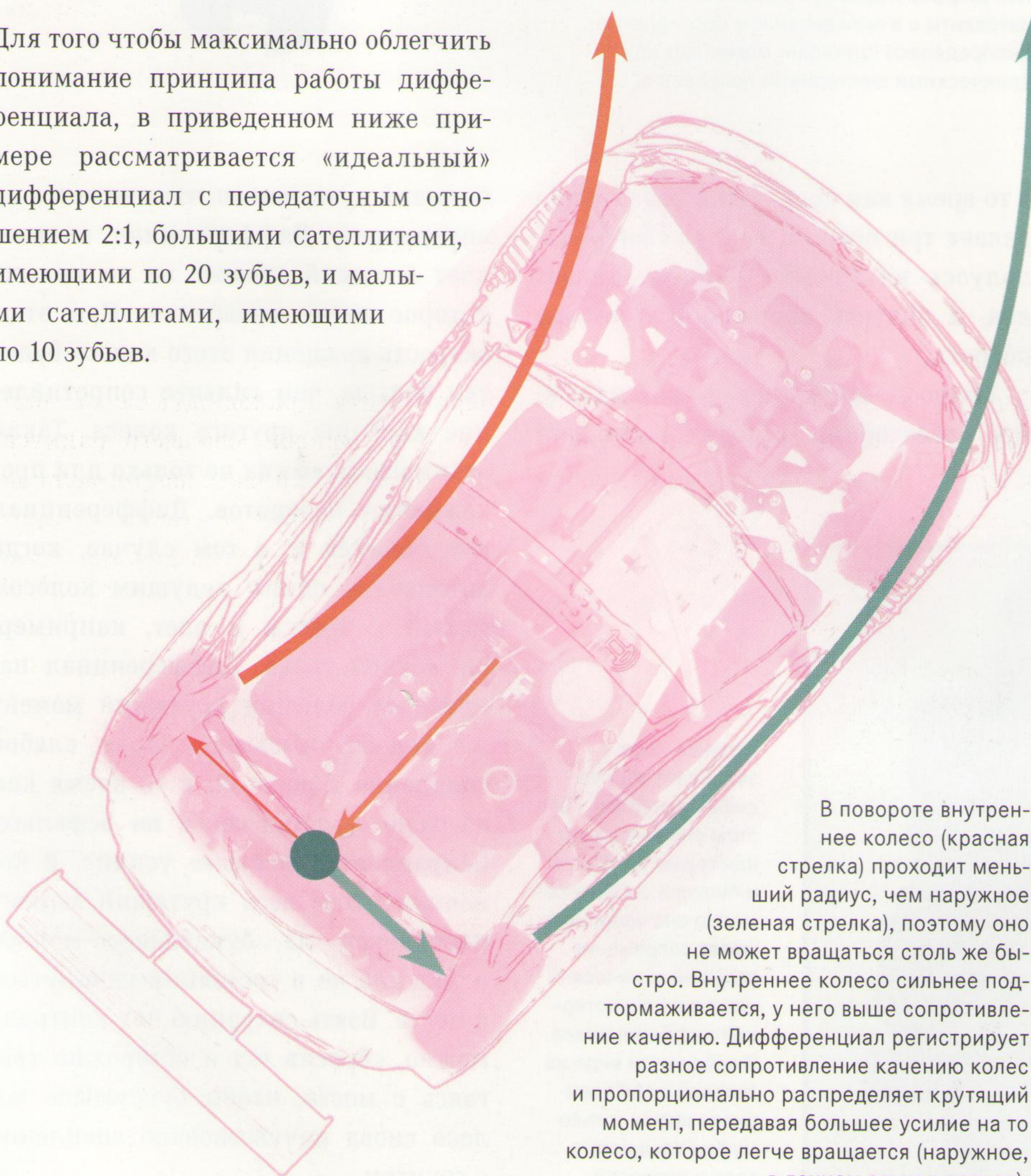
Вверху: Упрощенная модель дифференциала при прохождении поворота Справа: При прохождении поворота полуось a подтормаживается, а полуось b вращается быстрее. В экстремальном случае одна полуось блокируется, а другая вращается с удвоенной скоростью по отношению к закрепленному внутри корпуса валу дифференциала c .
