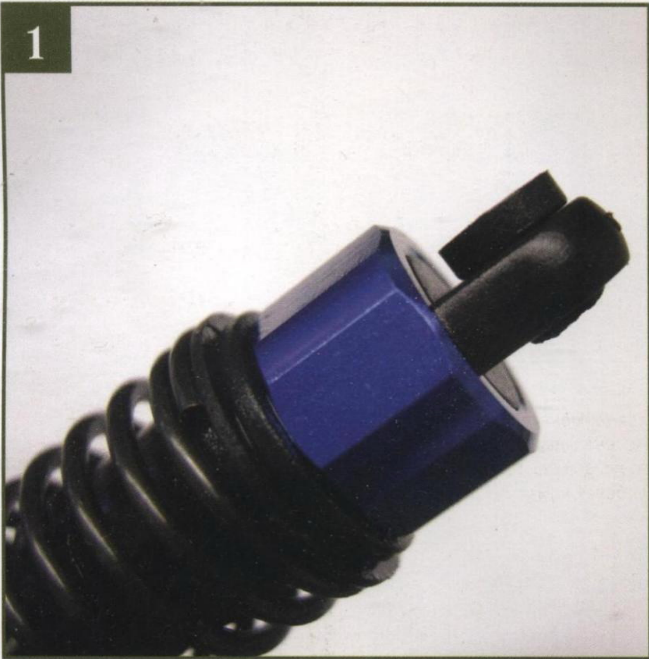
1 Верхний колпак амортизатора снабжен широкой плоской втулкой.
