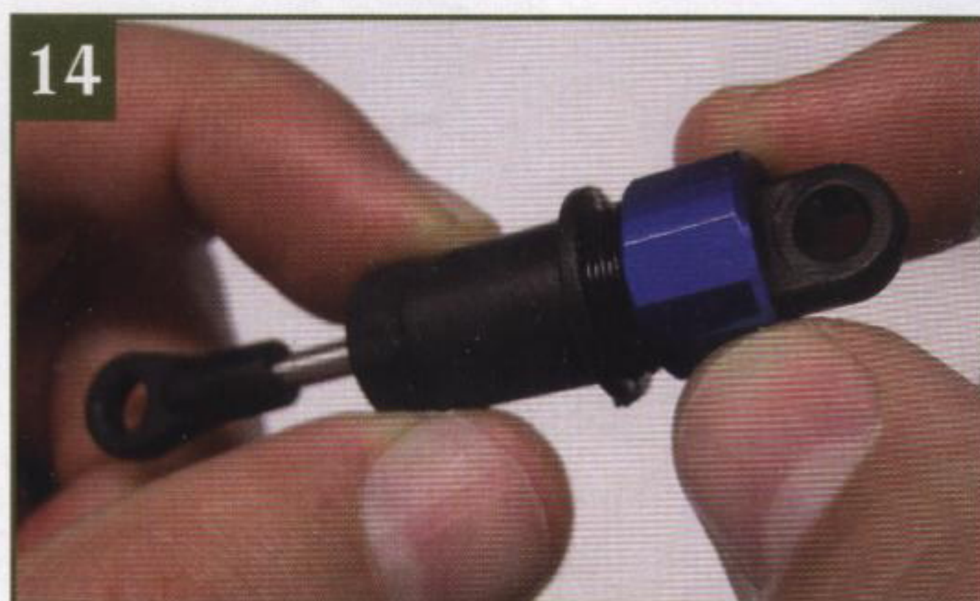
14 Закройте амортизатор крышкой.
