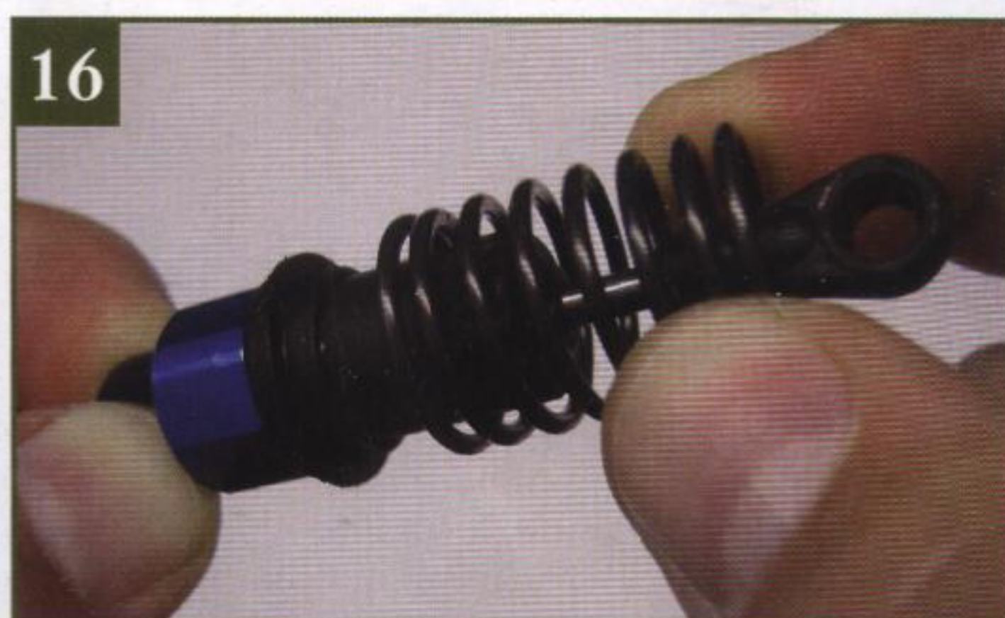
16 Уприте пружину в верхний упор.
