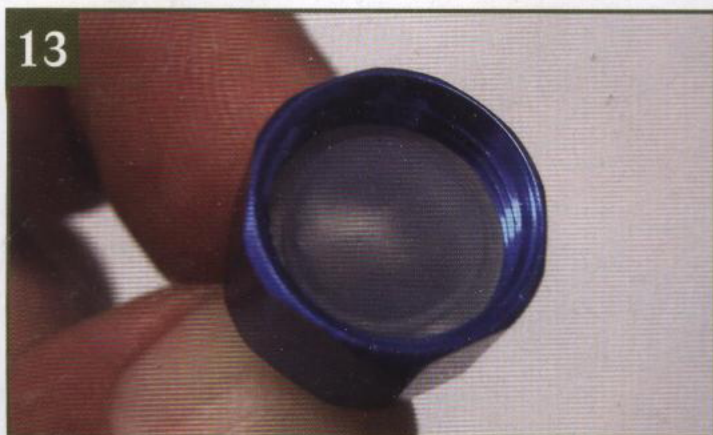
13 Поместите внутрь крышки амортизатора диафрагму, как показано на фото.
