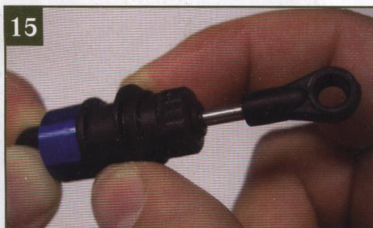
15 Наденьте на корпус верхний упор пружины.
