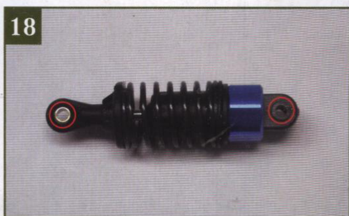
18 Завершите сборку первого амортизатора, установив на позиции, обведенные красным, шар наконечника амортизатора и втулку верхней крышки.
