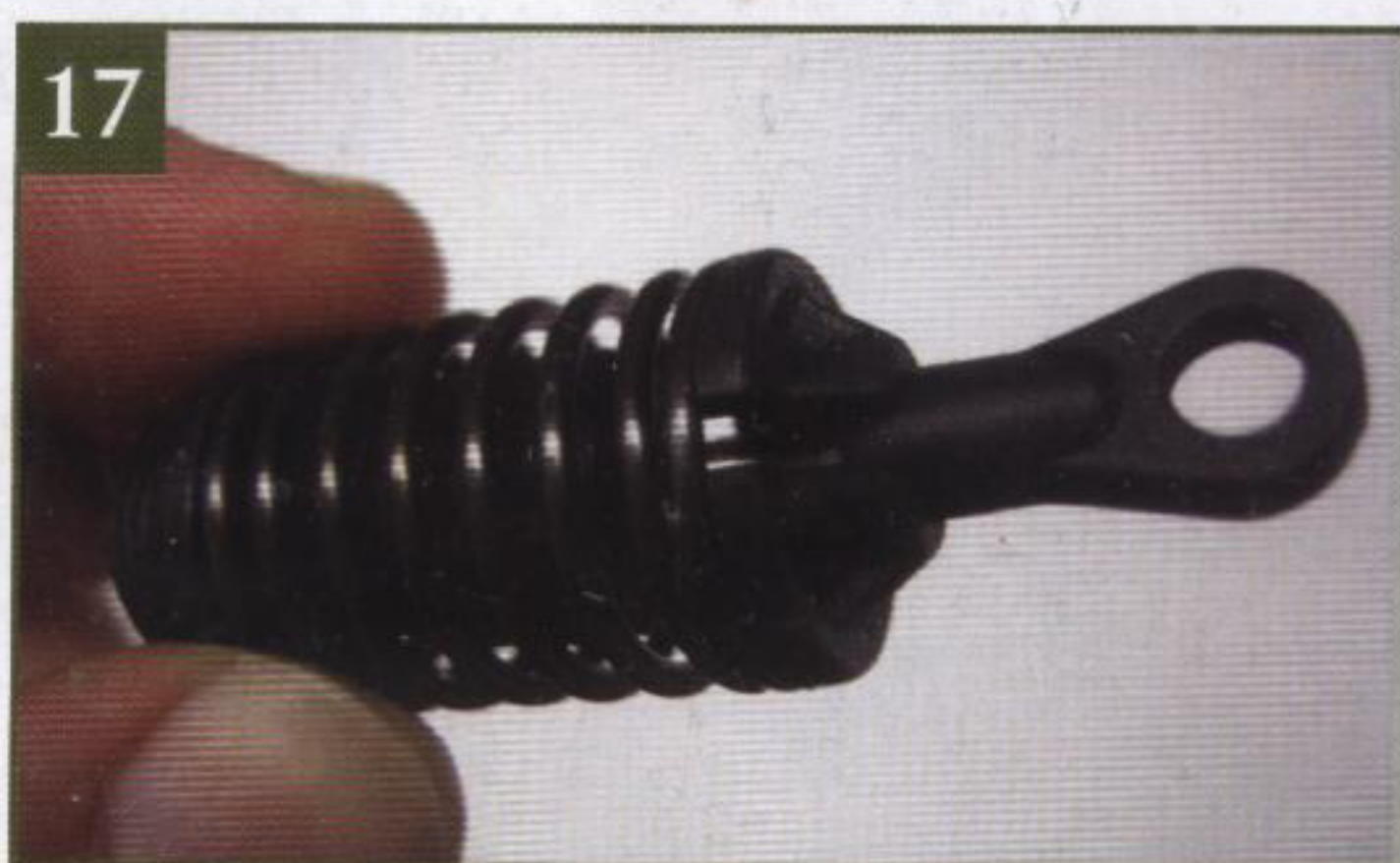
17 Зафиксируйте пружину, установив на поршень нижний упор пружины.
